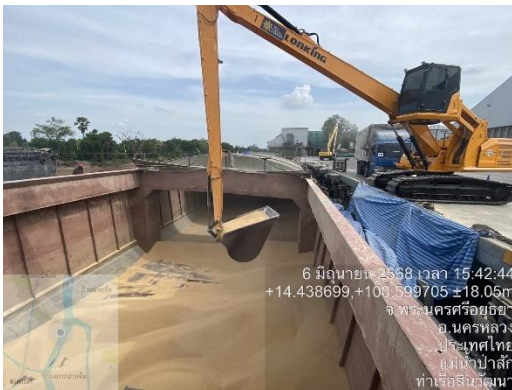
รูปที่ 2.2-18 การตักสินค้าด้วยแบ็คโฮหรือรถเกร็บไฟฟ้า (GRAB) หรือบุงกีของแบ็คโฮ
